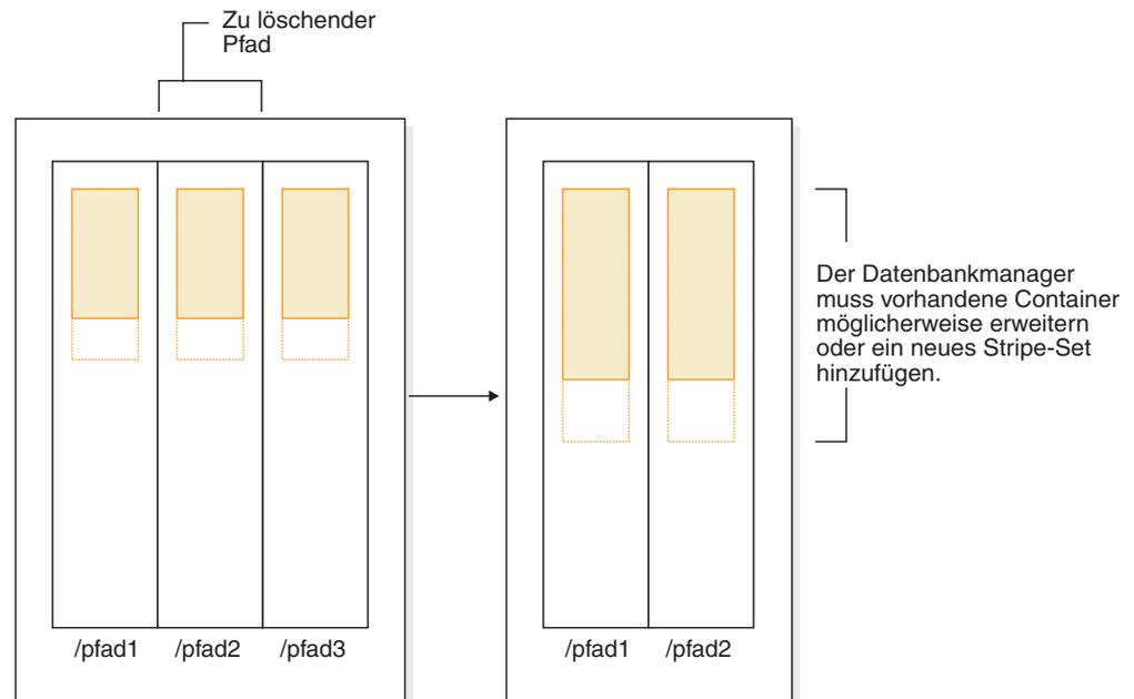
Abbildung 29. Löschen eines Speicherpfads und Neuverteilen eines Tabellenbereichs mit dynamischem Speicher
