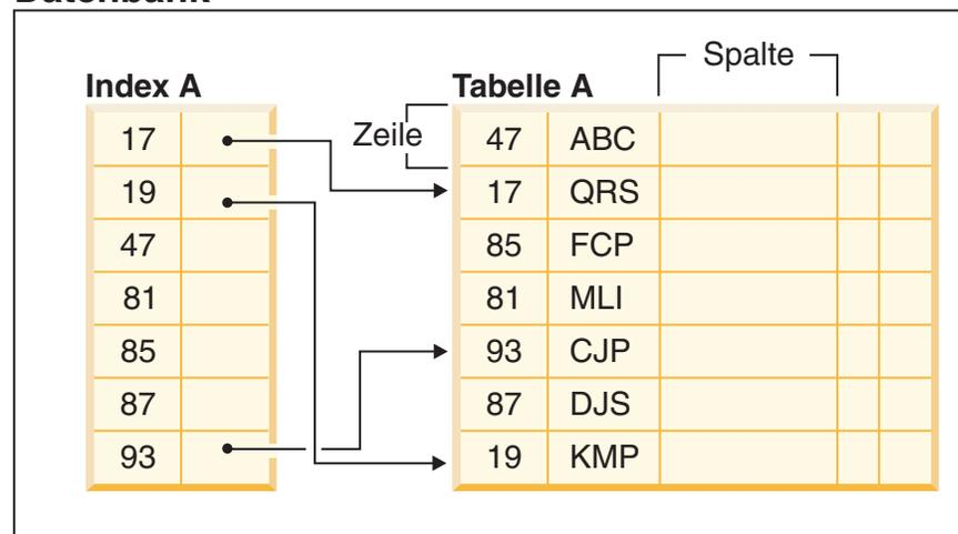
Abbildung 38. Beziehung zwischen einem Index und einer Tabelle
