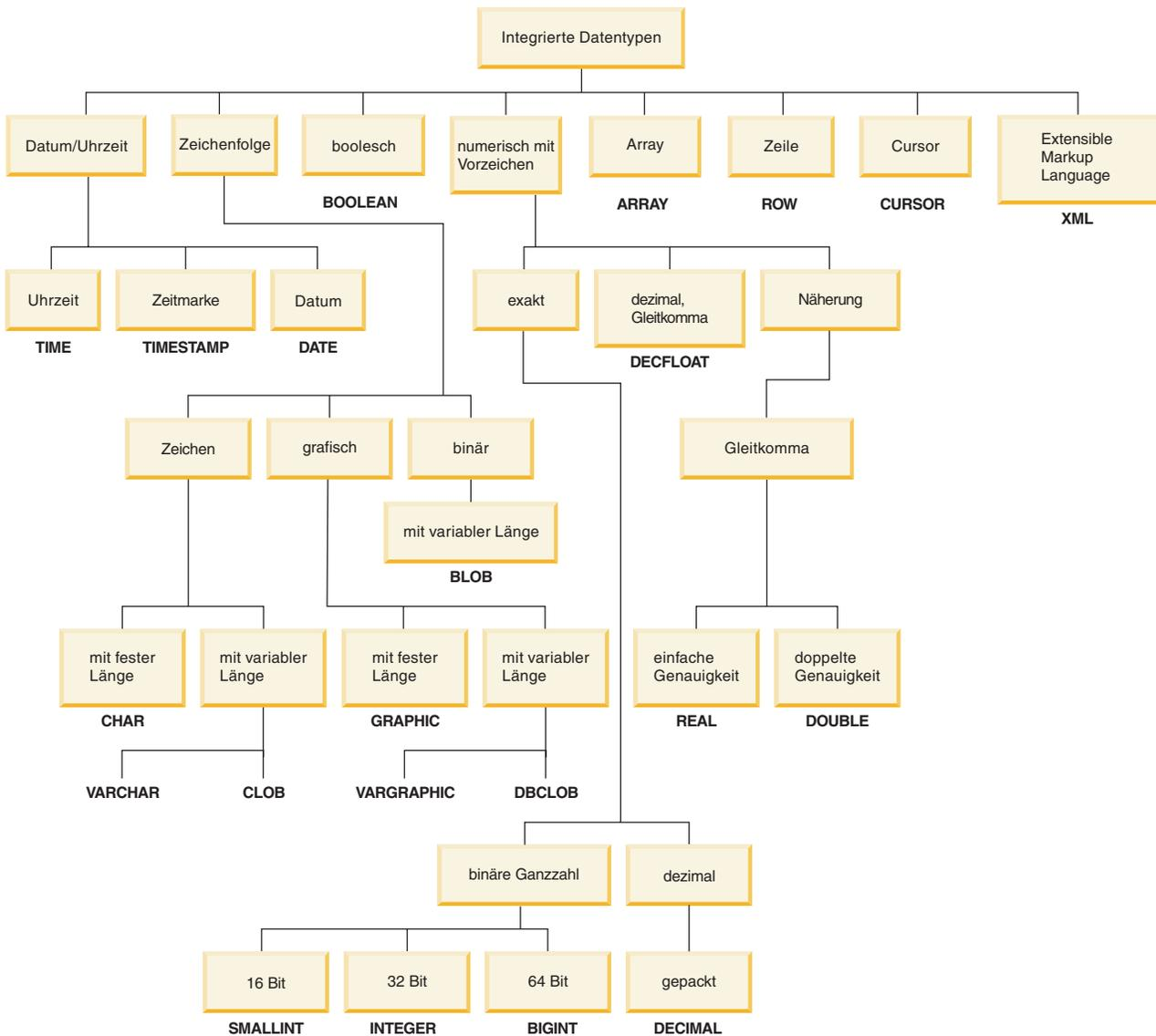
Abbildung 31. Integrierte Datentypen
