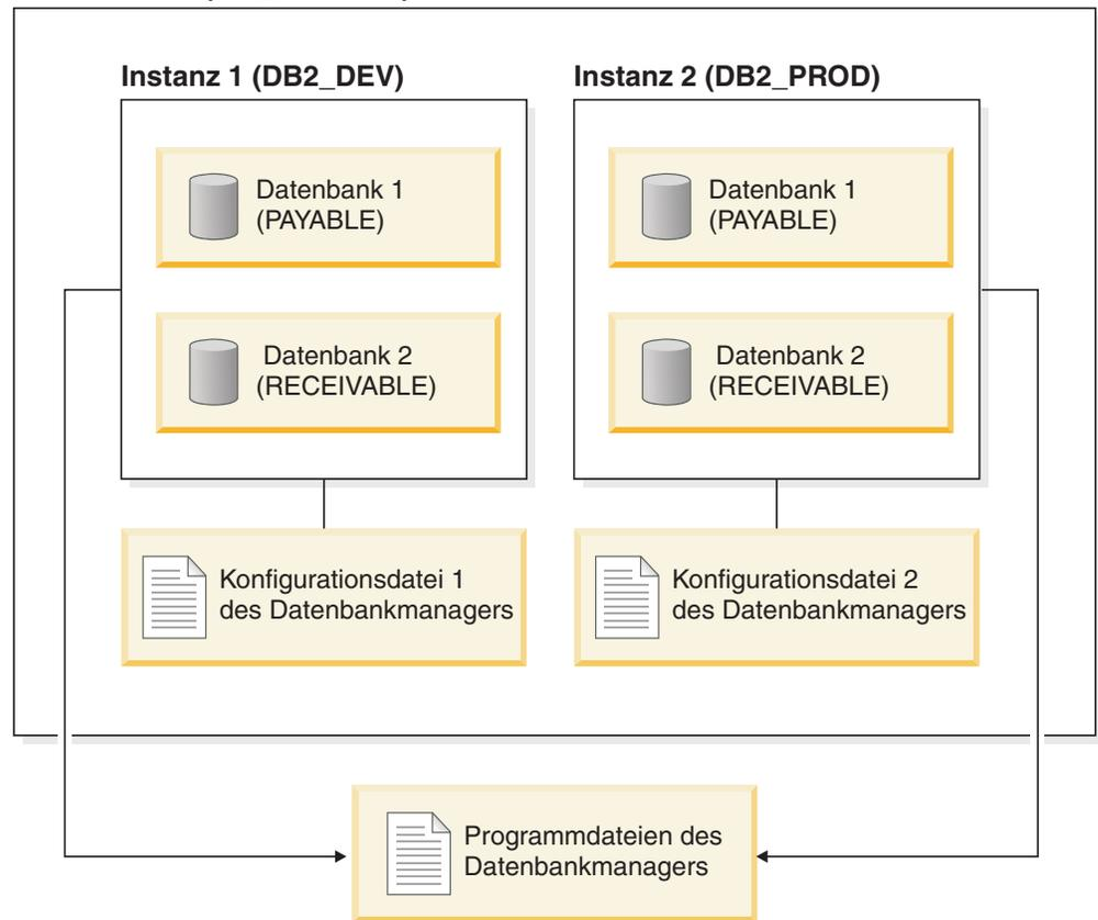
Abbildung 3. Hierarchische Beziehung zwischen DB2-Systemen, -Instanzen und -Datenbanken
