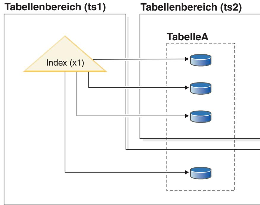
Abbildung 40. Nicht partitionierter Index für eine partitionierte Tabelle
