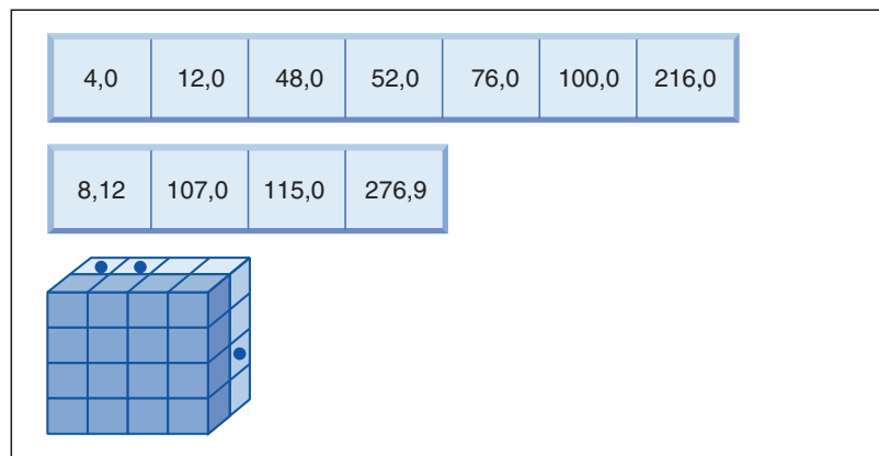
Abbildung 11. Funktionsweise eines Blockindex und eines Satz-ID-Index mit einer logischen ODER-Operation
